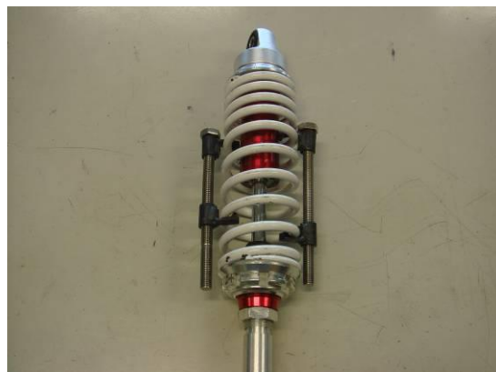
図 23 スプリングコンプレッサ使用時
