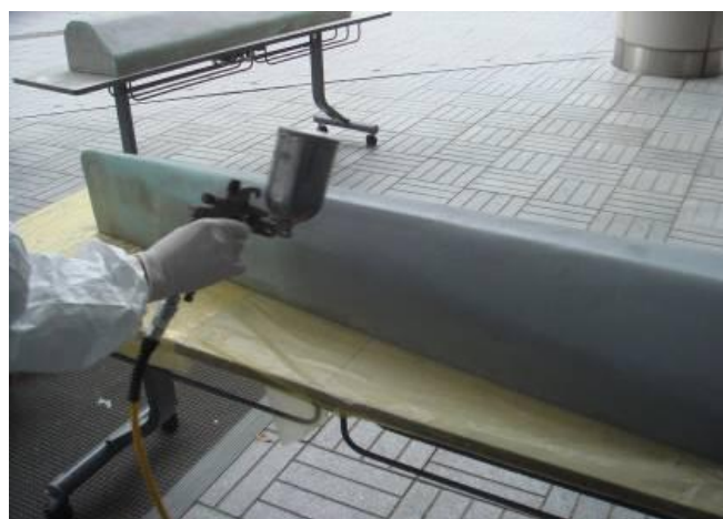
図 19 サーフェーサーを吹き付ける様子
