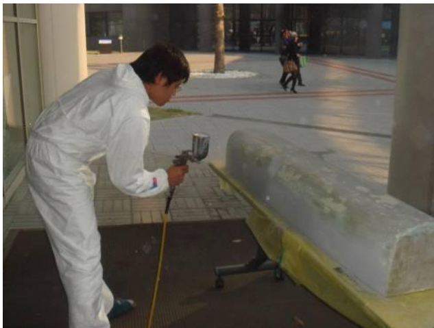
図 38 雄型の成形 (サーフェーサー)
