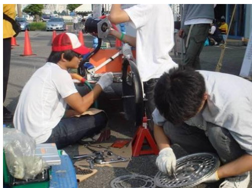
図 7 スプロケ交換の様子
