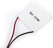
図1：熱電モジュール（TEC1-12706）
