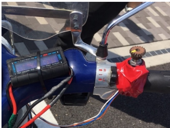
図6. 可変抵抗器を用いたスロットル
