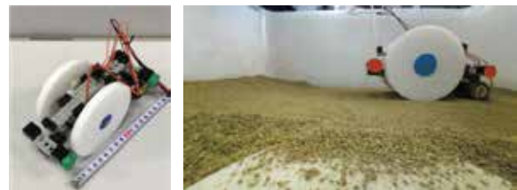
図-4 UGV挙動計測システムと物理パラメータ取得環境
