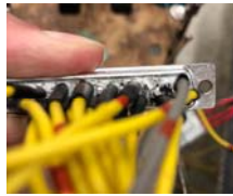
図3.D-subへのはんだ付け
