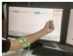
図2 筋電位波形を計測している様子
